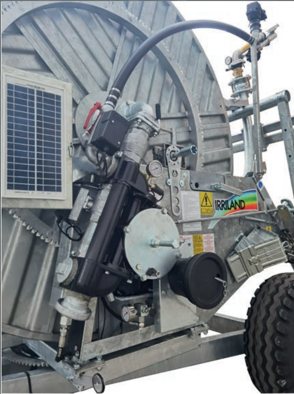
Turbina in ghisa flangiata sul riduttore Cast iron turbine flanged on gear-box Turbine en fonte bridé sur le boîte Turbinen aus Gusseisen auf dem Getriebe geflanscht Turbina en hierro fundido, embridado sobre al reductor
