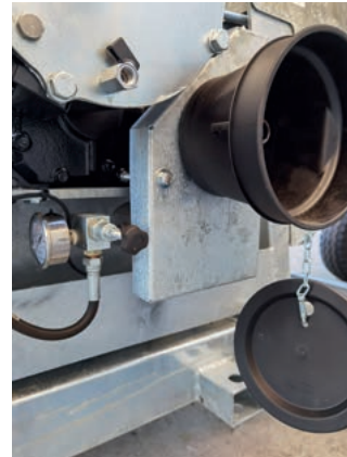
Freno idraulico sul riduttore Hydraulic gear box brake Freno hidraulico para caja reductora Hydraulische bremse Frein hydraulique sur le réducteur
